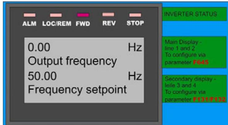
In Programming mode, the parameter group, the parameter description, the parameter number and the parameter value are shown on the display.
