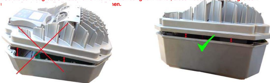
Es ist zu überprüfen, ob der Motor-Klemmkasten ausreichend stabil für die Montage des Umrichters ist. Der, am Motor montierte Umrichter darf auf keinen Fall mechanisch zusätzlich belastet werden. Falls es notwendig ist, das Display zu drehen, so sollte das Displaykabel dafür ausgesteckt werden, um eine Beschädigung zu vermeiden.
